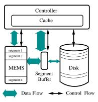
Figure 3. MEMS Caching Disk.
