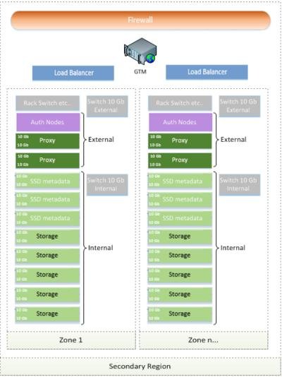
Rack Description: 45U ToR Switchs(4), Auth Nodes (1), Proxy Nodes (3), SSD Ring Nodes (4), Object Nodes (17)
